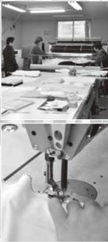
(上)CAD(コンピュータを使った製図システム)とつながっている裁断機 (下)特殊な縫い方ができるミシンで、細部にもこだわりを
